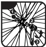
Posicione a ponta do garfo no eixo da roda, retire a porca da blocagem e passe o eixo da blocagem dentro do eixo furado da roda de modo que a alavanca de aperto fique do lado esquerdo da bicicleta (visto quando o usuário está em cima da mesma). Com a alavanca aberta, coloque a porca no eixo da blocagem e rosqueie até que esta encoste na superfície externa
