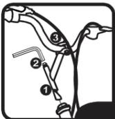
Introduza o suporte do guidão no canote do garfo que já está montado no quadro. Certifique-se de manter uma profundidade de inserção mínima de 75mm caso contrário, perde-se a garantia, além de correr o risco da peça soltar-se e causar um grave acidente. Em seguida, alinhe o guidão perpendicularmente à roda dianteira e com uma chave Allen, aperte o parafuso central da caixa de direção até sua fixação total.
