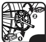
Os pedais possuem as inscrições R/Right (direito em inglês), e L/Left (esquerdo em Inglês) impressas na ponta do eixo, utilizando uma chave de boca de 15mm, rosqueie no sentido horário, o pedal R na rosca da pedivela direito (sob o ponto de vista do ciclista) apertando até seu limite de trava.
